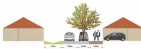
Profil de voie compacte, noue et trottoir
